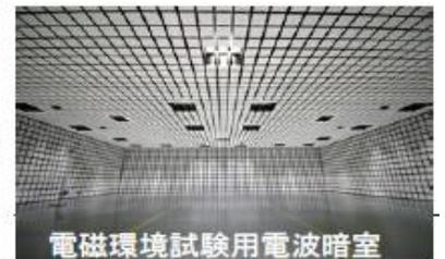
電磁環境試験用電波暗室
